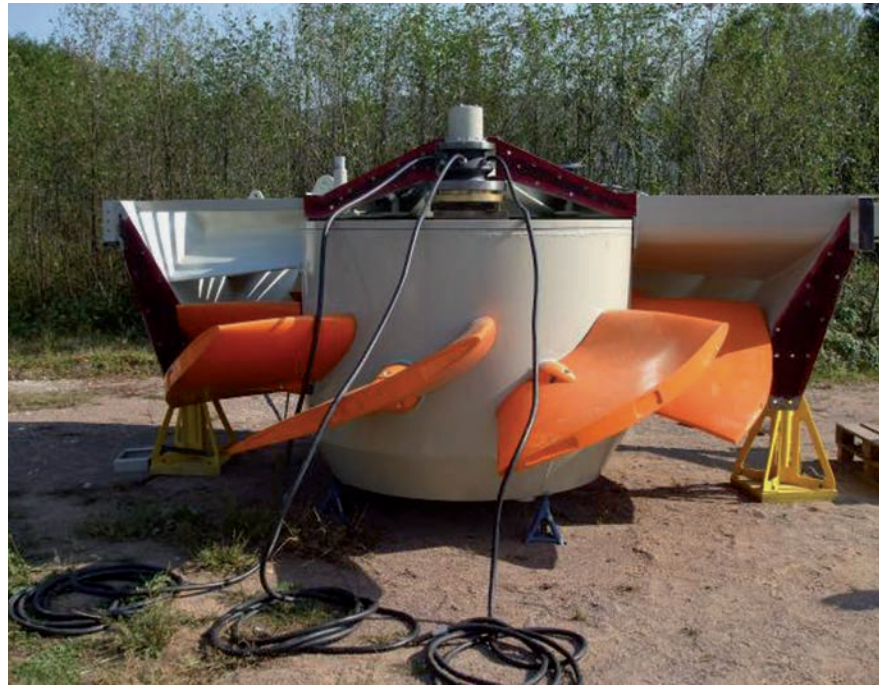
Bild 4: Das zusammengebaute Laufrad der VLH-Turbine [1]
