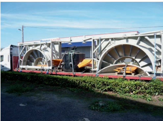
Bild 3: Das für den Transport geteilte Turbinengehäuse einer VLH [1]
